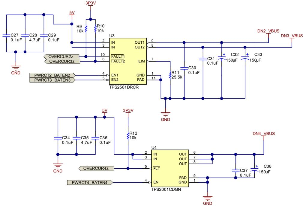
图 42. VBUS Power Switch Implementation
