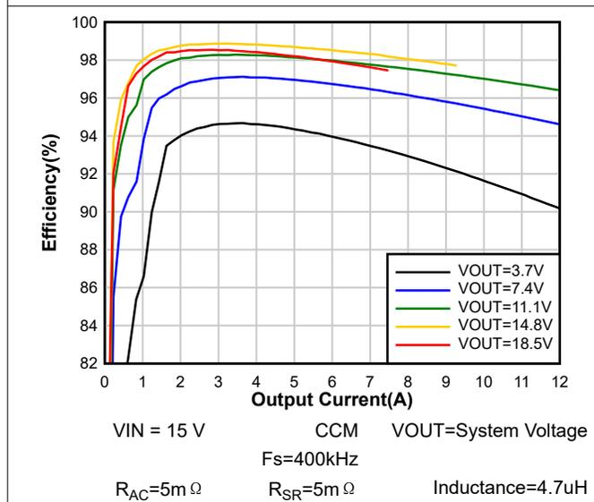
图 7-7. System Efficiency
