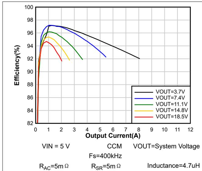
图 7-5. System Efficiency
