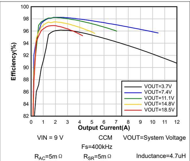
图 7-6. System Efficiency
