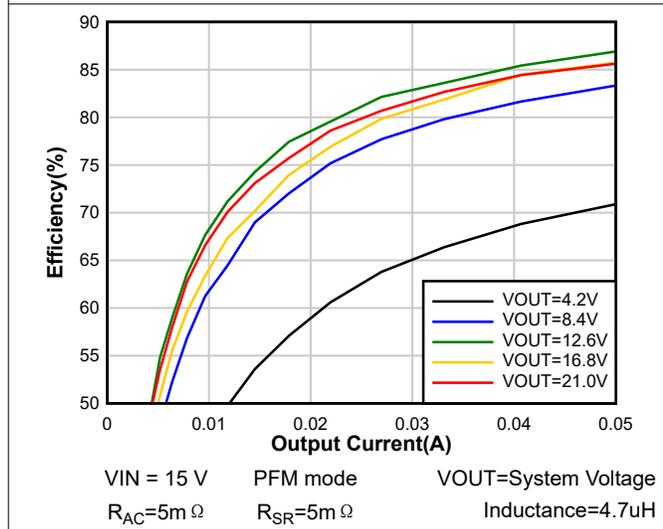
图 7-3. Light Load System Efficiency
