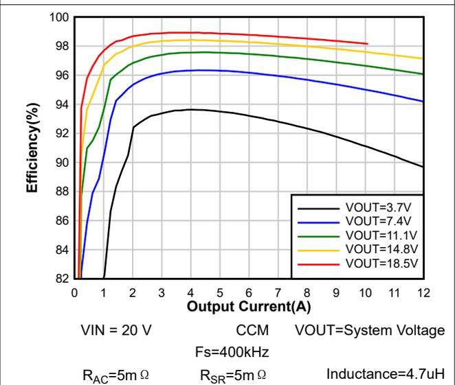
图 7-8. System Efficiency
