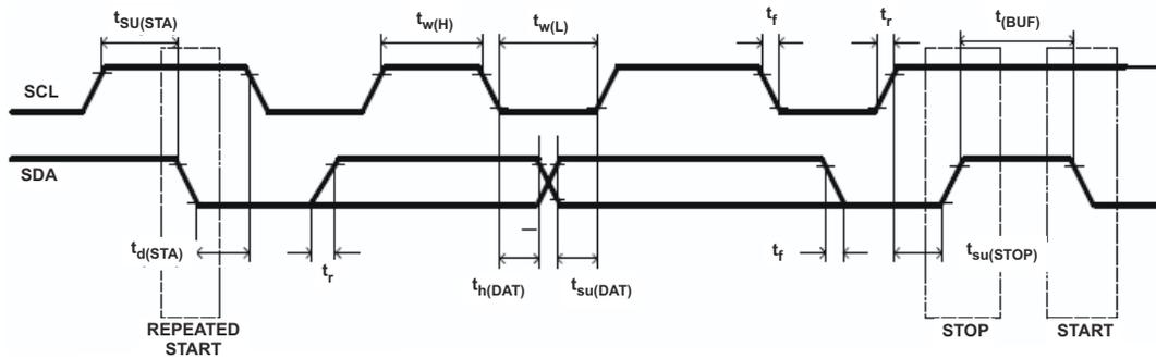
图 6-1. I<sup>2</sup>C-Compatible Interface Timing Diagrams
