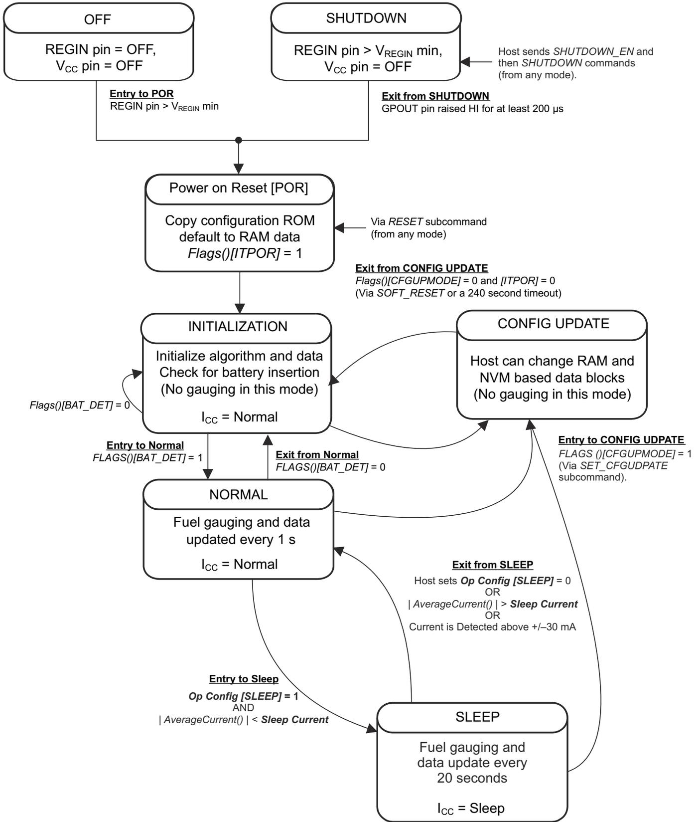
图 7-5. Power Mode Diagram
