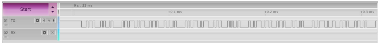
图 9-10. UART Write Command
