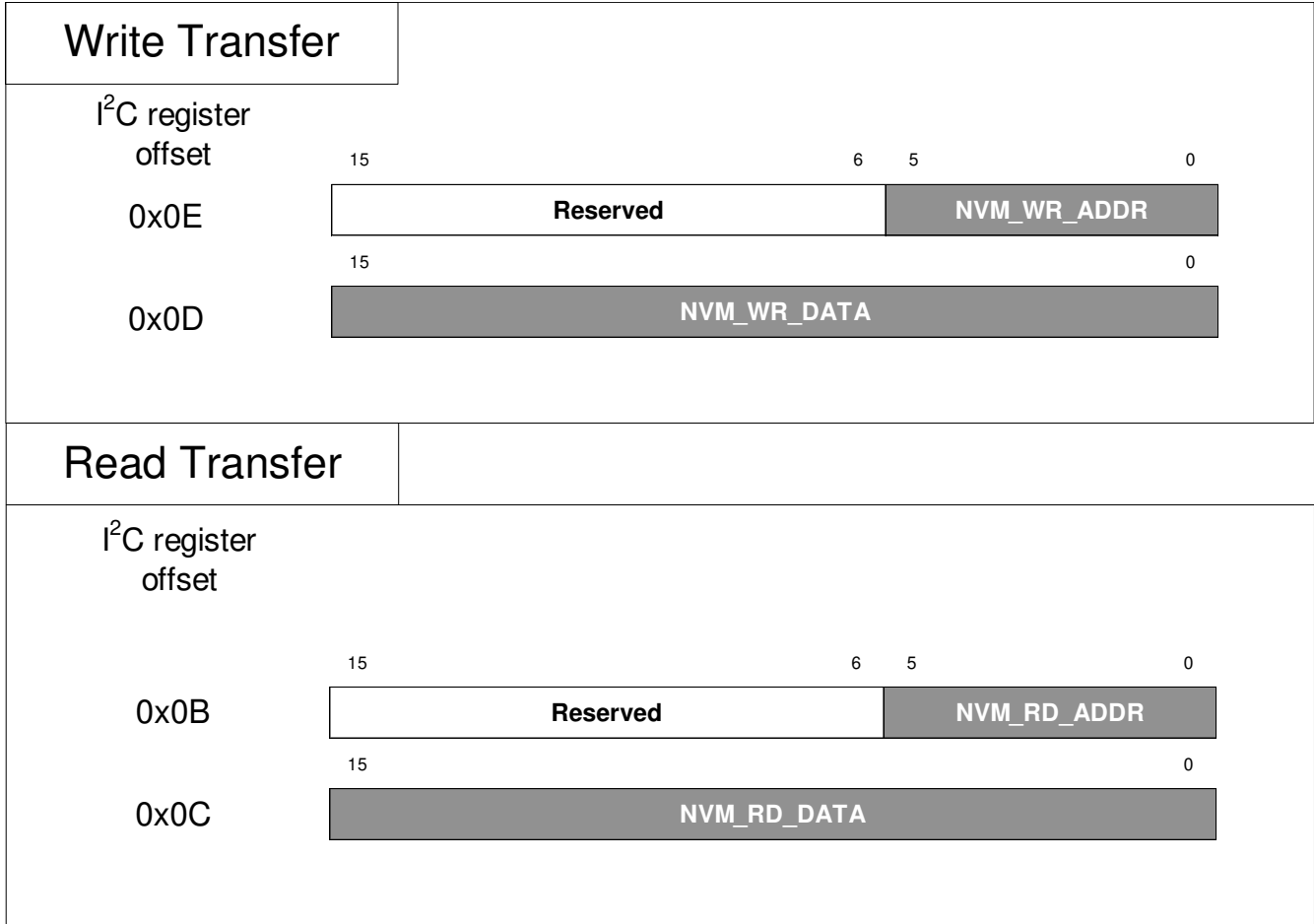
图 10-11. 使用 I 2 C 的 EEPROM 直接访问
