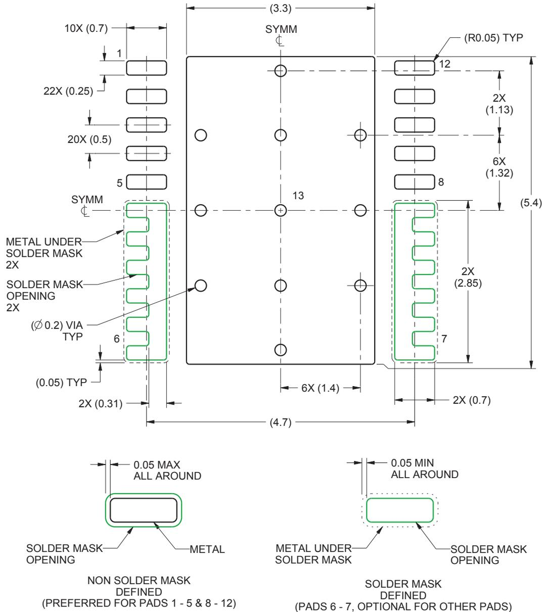
1. 所有线性尺寸的单位均为毫米。括号中的任何尺寸仅供参考。尺寸和公差值符合 ASME Y14.5M 标准。
