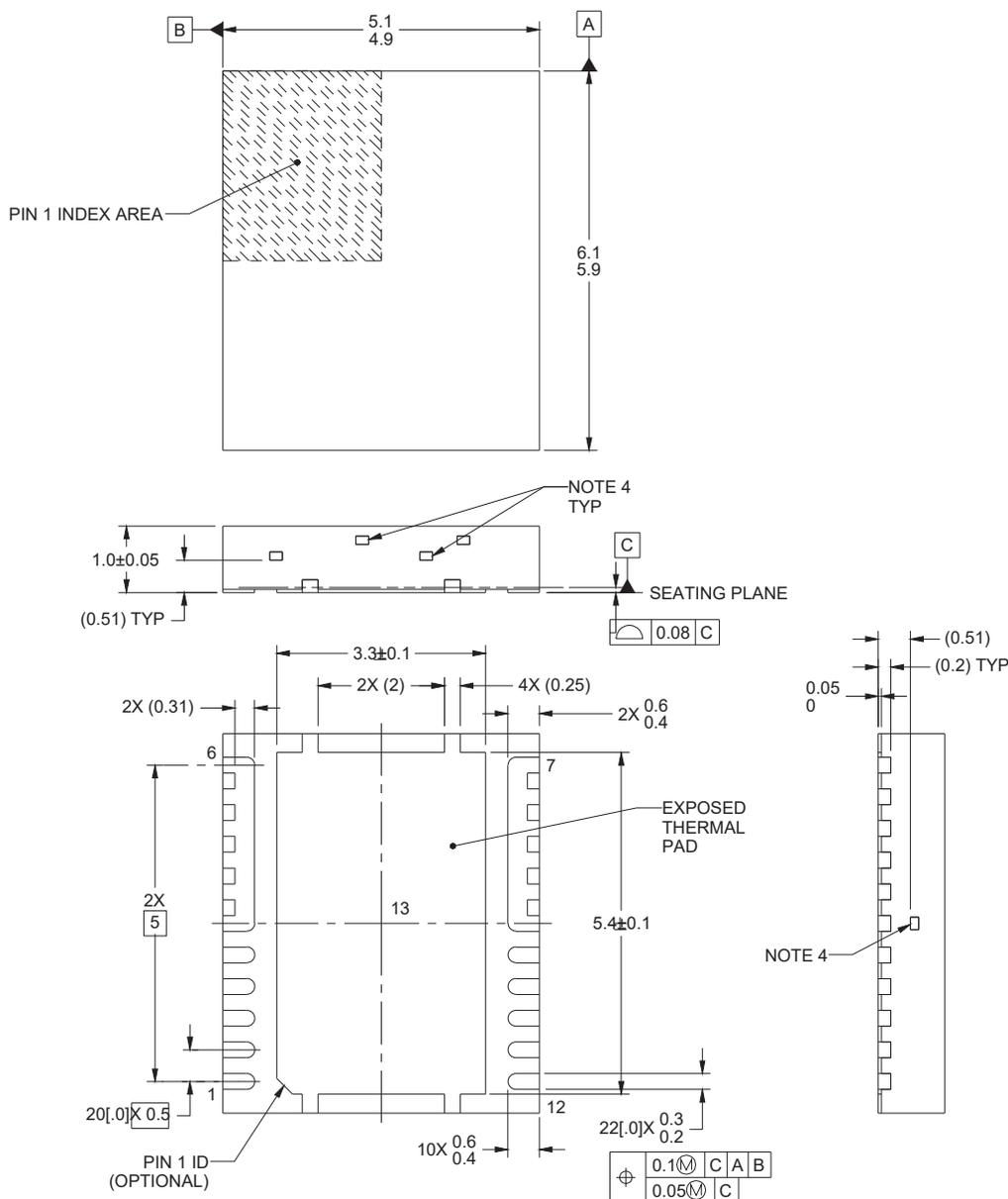
1. 所有线性尺寸的单位均为毫米。括号中的任何尺寸仅供参考。尺寸和公差值符合 ASME Y14.5M 标准。
