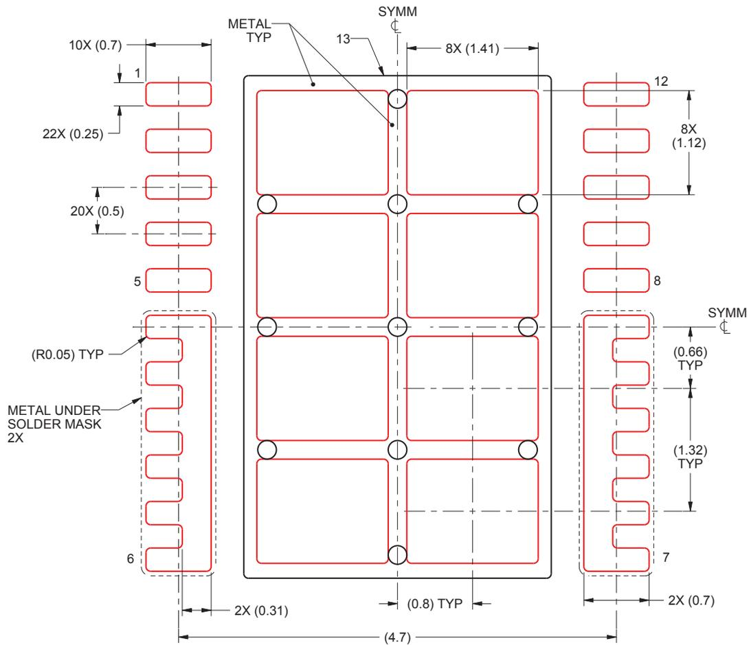
1. 所有线性尺寸的单位均为毫米。括号中的任何尺寸仅供参考。尺寸和公差值符合 ASME Y14.5M 标准。
