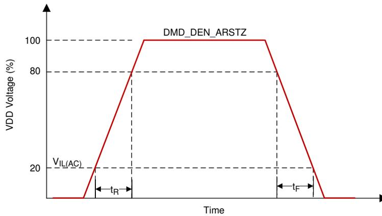
图 6-9. LVCMOS Rise, Fall Time Slew Rate
