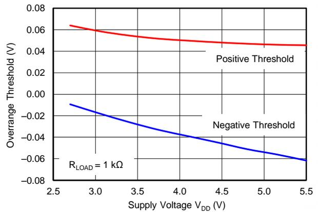
**Figure 30. OVERRANGE TRIP LEVEL vs POWER SUPPLY**
