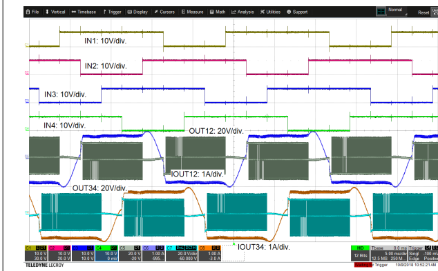
图 8-9. 关断状态制动模式下的步进电机半步运行
