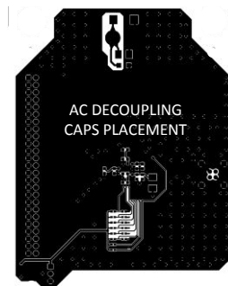
图 7-12. DS90UR241-Q1 示例 EMC 布局
