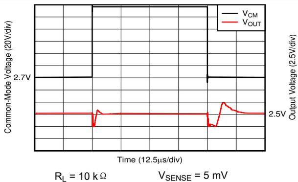
图 6-23. Common-Mode Voltage Fast Transient Pulse, A5 devices
