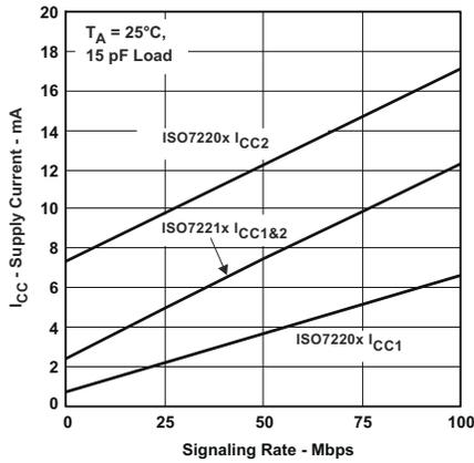
图 5-2. 3.3V<sub>RMS</sub> 电源电流与信号传输速率 (Mbps) 间的关系
