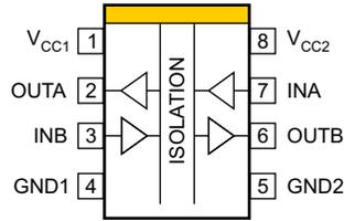
图 4-2. ISO7221x D 封装，8 引脚 SOIC（顶视图）
