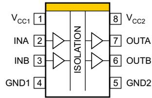
图 4-1. ISO7220x D 封装，8 引脚 SOIC（顶视图）
