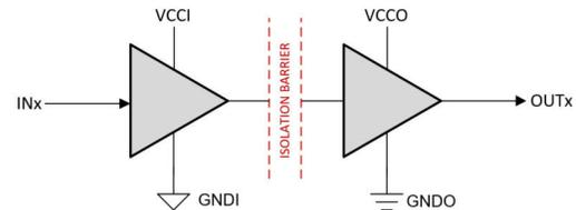
$V_{CCI}$  和  $GNDI$  分别是输入通道的电源和接地连接引脚。
