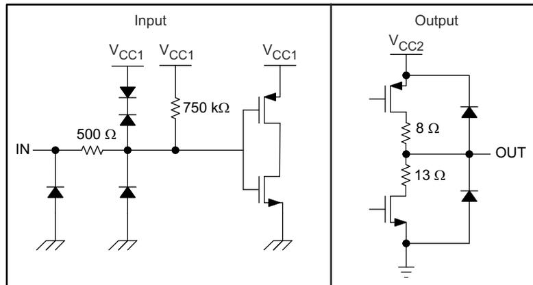
图 7-1. 器件 I/O 原理图
