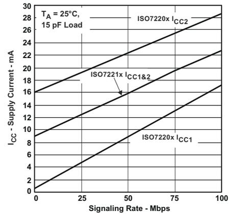
图 5-3. 5-V<sub>RMS</sub> 电源电流与信令速率 (Mbps) 间的关系
