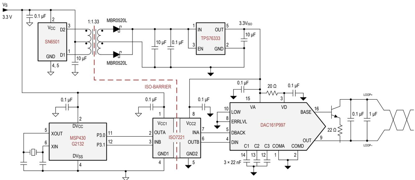
图 8-1. 隔离式 4mA 至 20mA 电流环路
