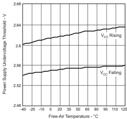
图 5-10. V<sub>CC</sub> 欠压阈值与自然通风条件下的温度间的关系
