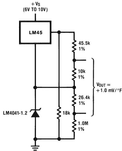
Figure 20. Fahrenheit Thermometer
