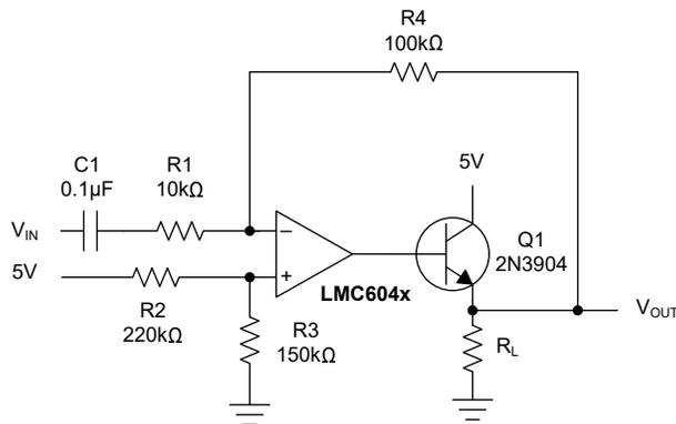
图 6-9. 交流耦合功率电源放大器
