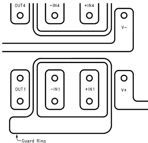
图 6-14. PCB 布局中的防护环示例
