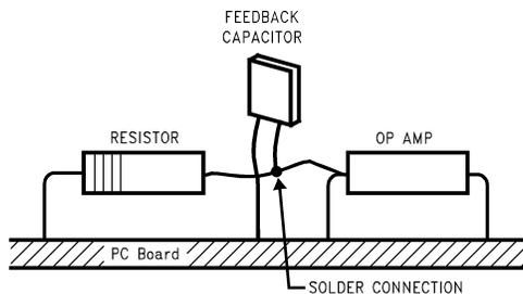
注意：输入引脚从 PCB 上提出并直接焊接到元件上。所有其他引脚均连接到 PCB。
