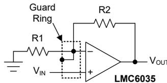
图 6-11. 防护环的典型连接：同相放大器
