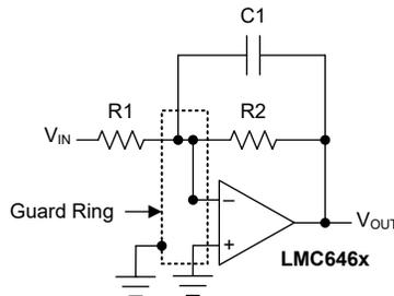
图 6-10. 防护环的典型连接：反相放大器
