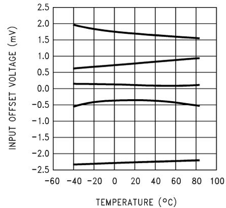
图 5-2. 偏移电压与五个代表单元的温度
