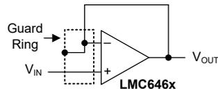
图 6-12. 防护环的典型连接：跟随器
