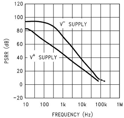
图 5-12. 电源抑制比与频率间的关系
