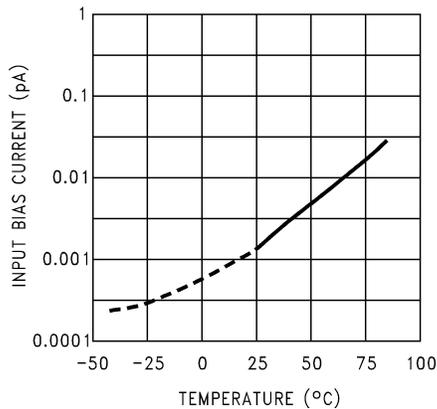
图 5-3. 输入偏置电流与温度间的关系
