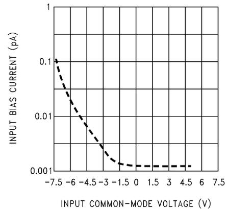
图 5-4. 输入偏置电流与输入共模电压
