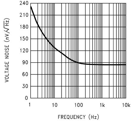
图 5-8. 输入电压噪声与频率间的关系
