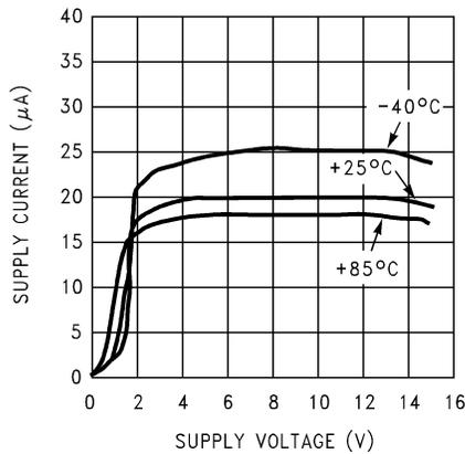
图 5-1. 电源电流与电源电压间的关系
