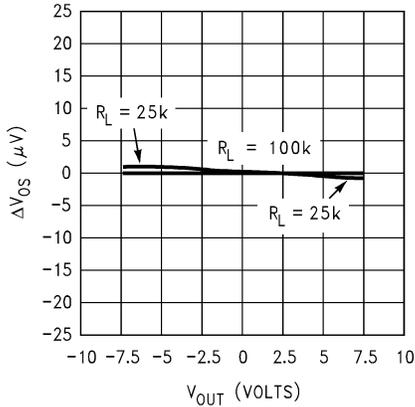
图 5-17. 增益误差 ( $V_{OS}$  与  $V_{OUT}$ )
