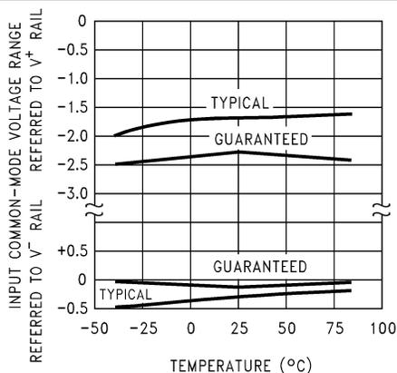
图 5-5. 输入偏置电流电压范围与温度
