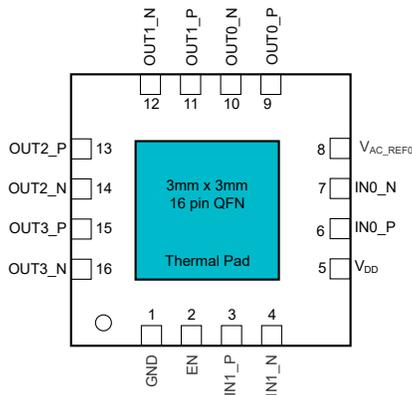
图 6-1. LMK1D2102: RGT Package 16-Pin VQFN
