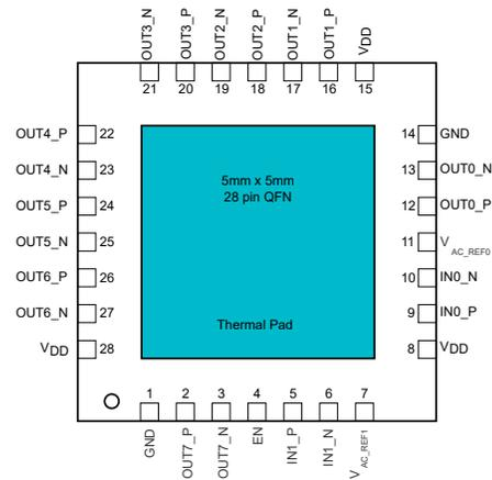
图 6-2. LMK1D2104: RHD Package 28-Pin VQFN
