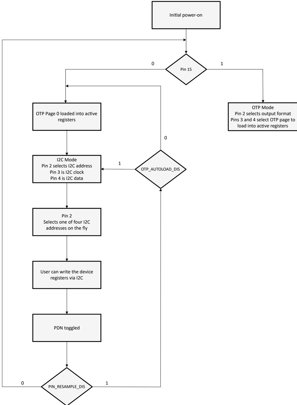
图 7-2. LMK3H0102 简化编程流程
