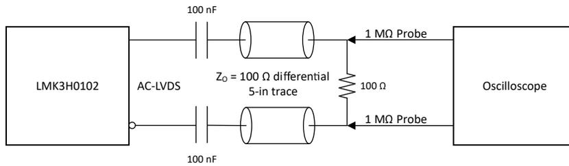
图 6-2. 器件测试期间的交流 LVDS 输出配置
