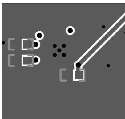
图 10-2. LMK3H0102 的 PCB 布局示例，底层
