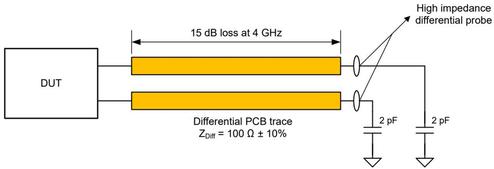
图 6-5. PCIe 器件测试期间的 LP-HCSL 输出配置
