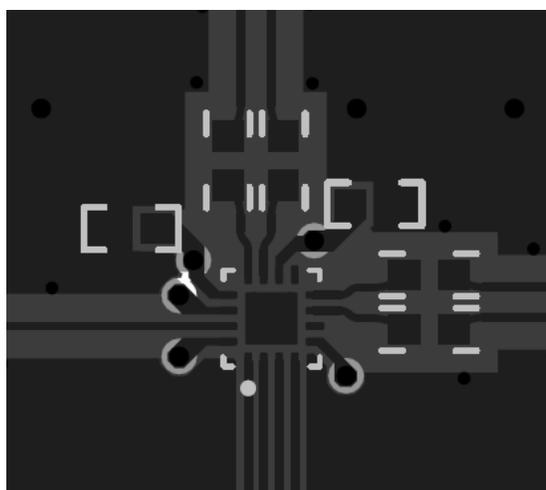
图 10-1. LMK3H0102 的 PCB 布局示例，顶层
