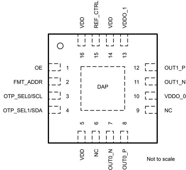
图 4-1. LMK3H0102 16 引脚 TQFN 顶视图
