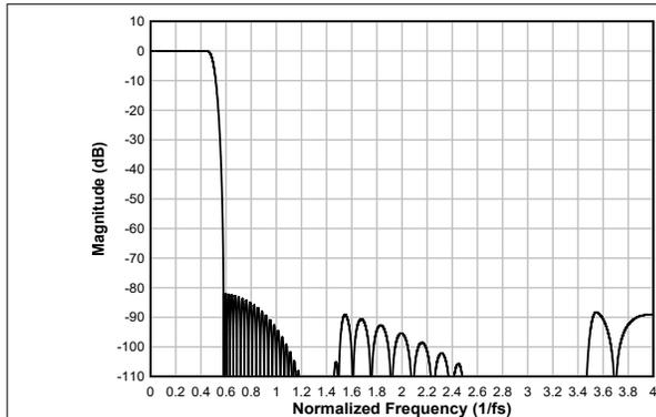
图 7-23. 线性相位内插滤波器幅度响应
