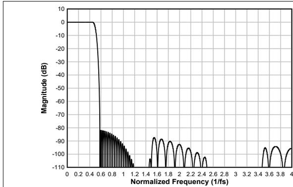
图 7-21. 线性相位内插滤波器幅度响应
