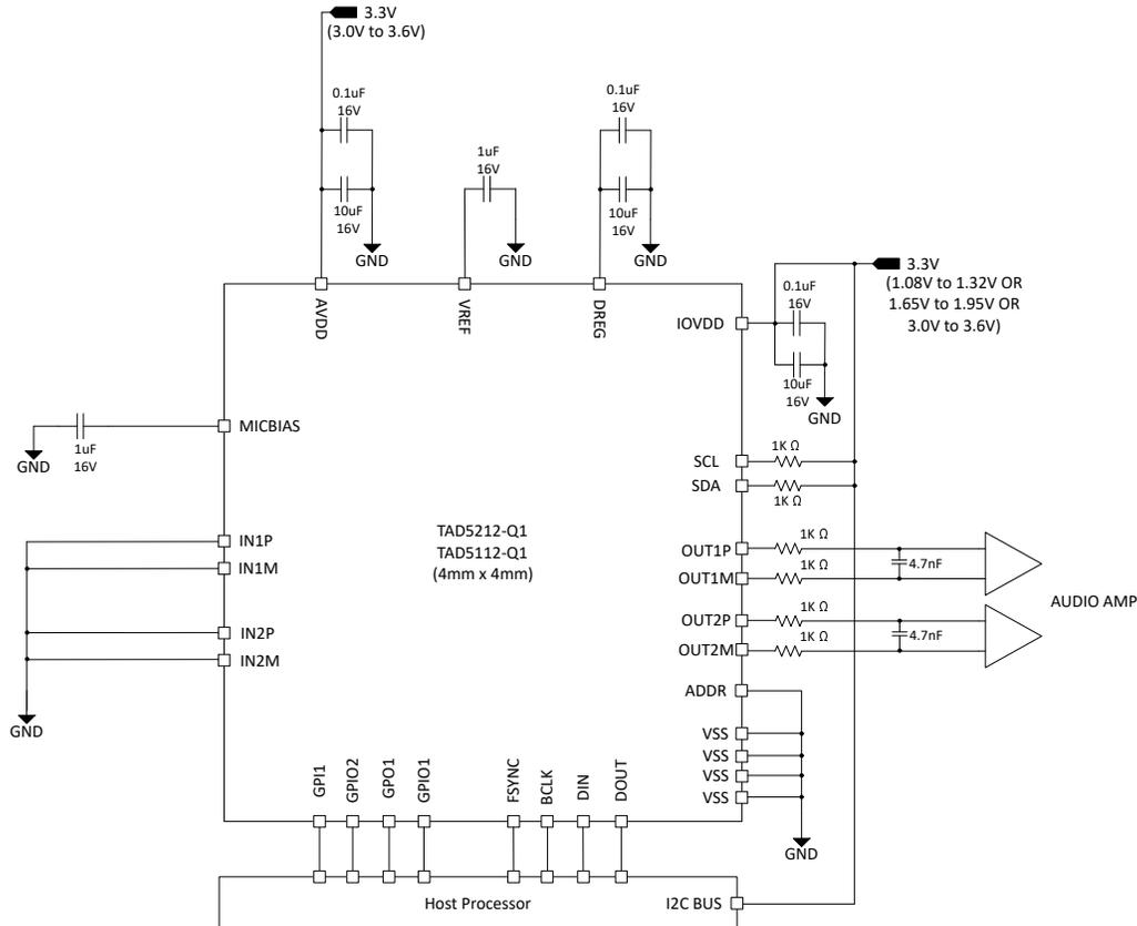
图 8-1. 立体声线路输出方框图
