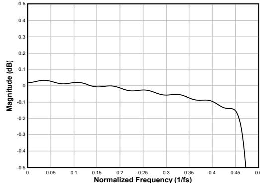
图 7-18. 线性相位内插滤波器通带纹波
