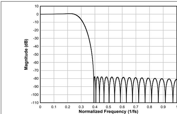
图 7-27. 线性相位内插滤波器幅度响应
