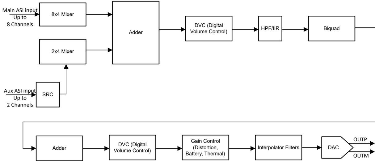
图 7-15. DAC 信号链处理流程图
