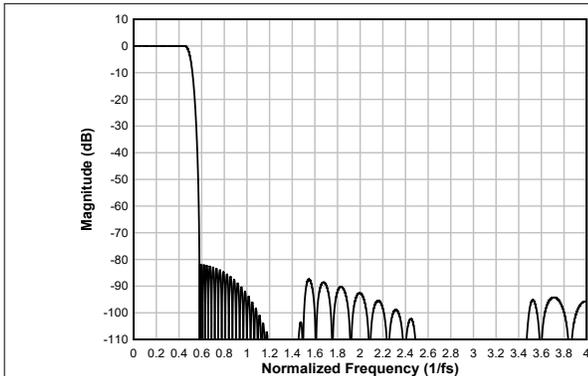
图 7-19. 线性相位内插滤波器幅度响应
