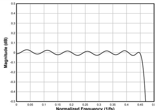
图 7-20. 线性相位内插滤波器通带纹波
