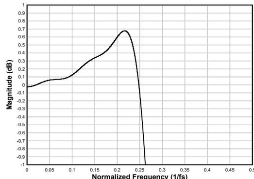
图 7-28. 线性相位内插滤波器通带纹波
