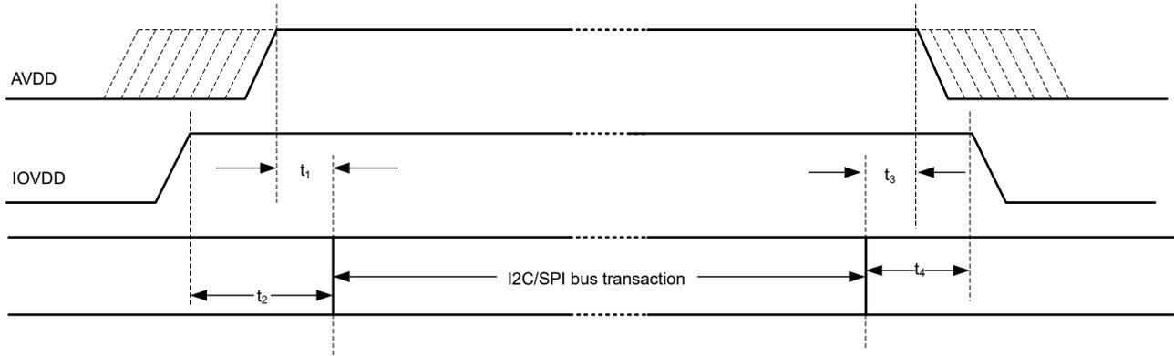
图 9-1. 电源时序要求时序图
