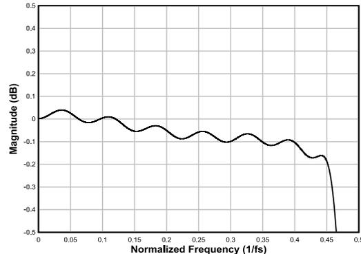
图 7-26. 线性相位内插滤波器通带纹波
