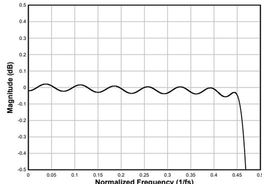
图 7-24. 线性相位内插滤波器通带纹波
