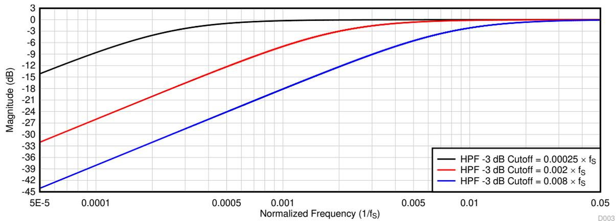
图 7-16. HPF 滤波器频率响应图
