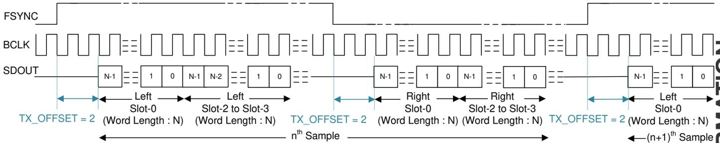
图 7-11. LJ 协议时序 (TX\_OFFSET = 2)
