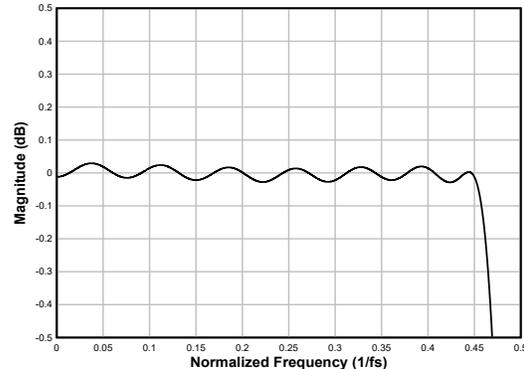
图 7-22. 线性相位内插滤波器通带纹波
