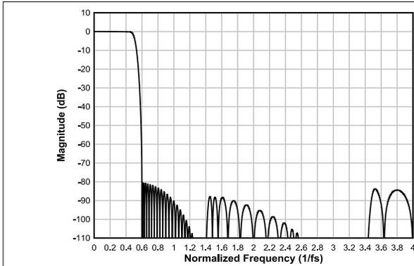
图 7-17. 线性相位内插滤波器幅度响应
