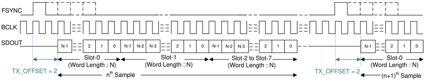
图 7-3. TDM 模式协议时序 (PASI\_TX\_OFFSET = 2)
