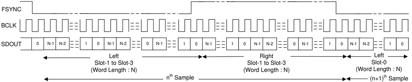
图 7-8. I²S 协议时序 (无空闲 BCLK 周期, PASI\_TX\_OFFSET = 0)
