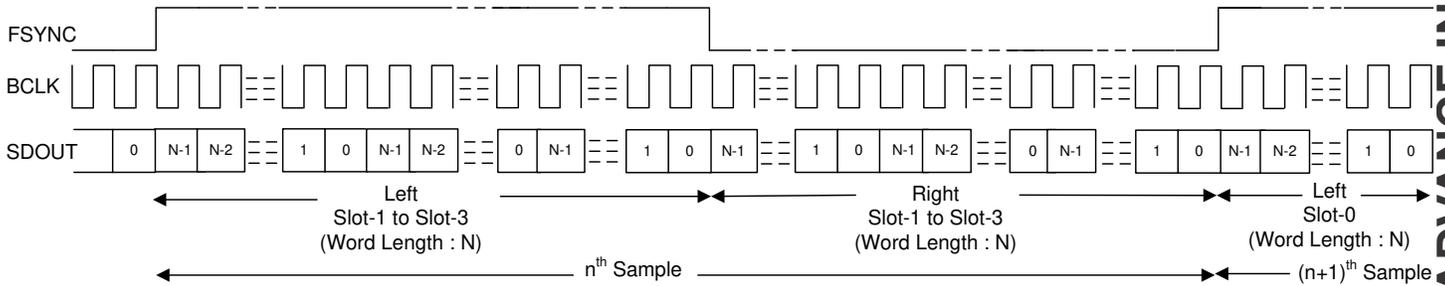
图 7-12. LJ 协议时序 (无空闲 BCLK 周期, TX\_OFFSET = 0)
