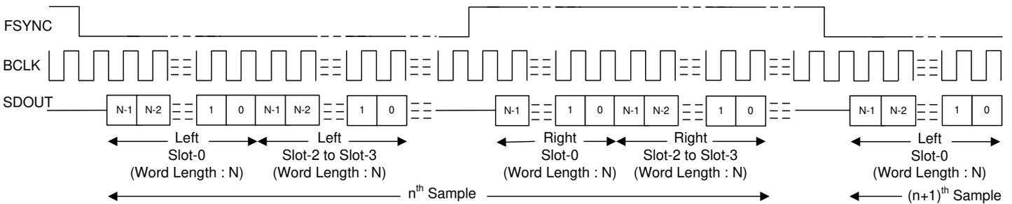
图 7-6. I<sup>2</sup>S 模式标准协议时序 (PASI\_TX\_OFFSET = 0)
