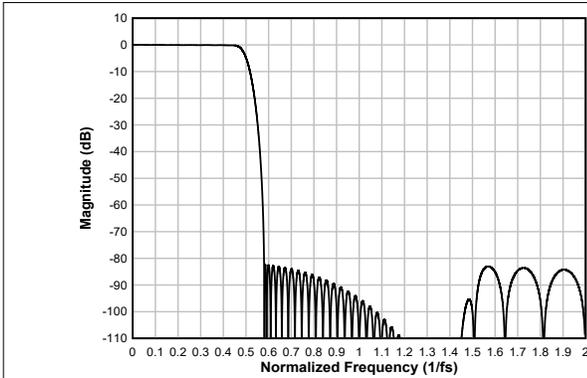
图 7-25. 线性相位内插滤波器幅度响应
