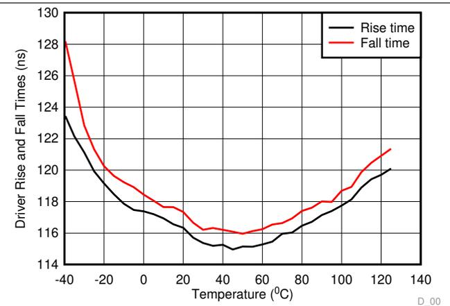
图 4. Driver Rise or Fall Time vs Temperature
