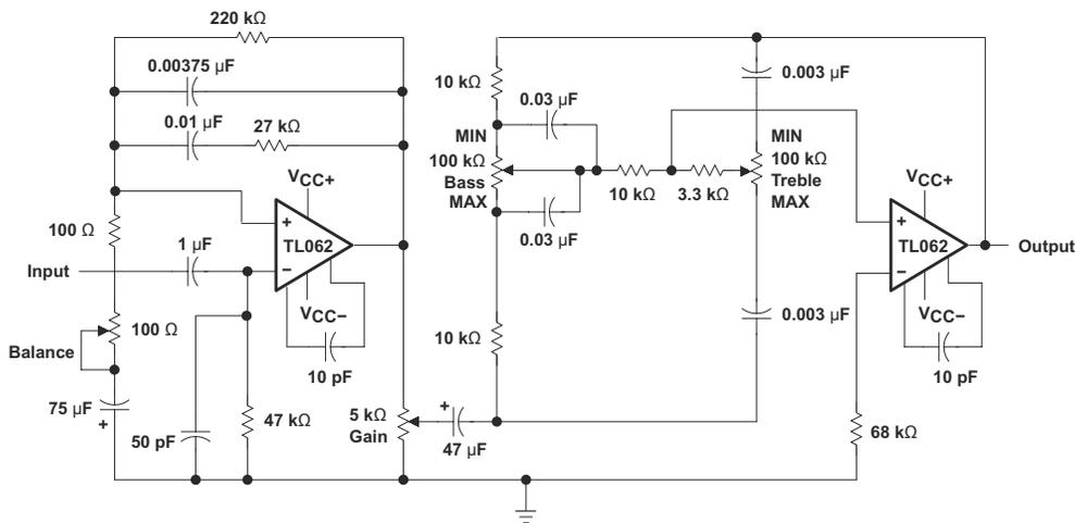
图 9-11. IC Preamplifier
