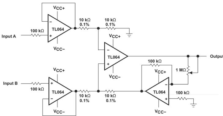
图 9-3. Instrumentation Amplifier
