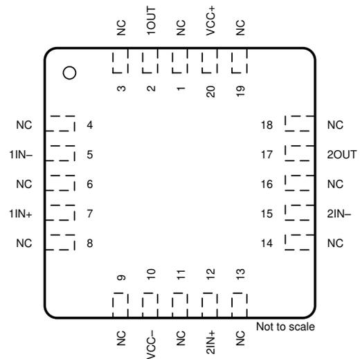
图 5-4. TL062 FK Package, 20-Pin LCCC (Top View)
