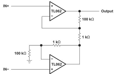
图 9-10. Instrumentation Amplifier
