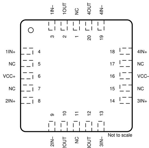
图 5-5. TL064 FK Package, 20-Pin LCCC (Top View)
