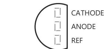
图 4-2. LP 封装 3 引脚 TO-92 顶视图
