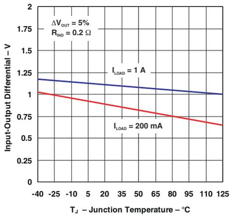
图 6-3. Dropout Voltage
