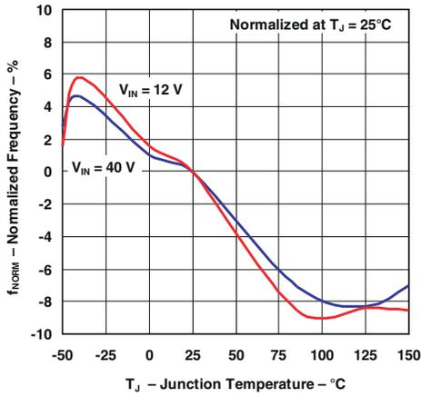
图 6-7. Oscillator Frequency
