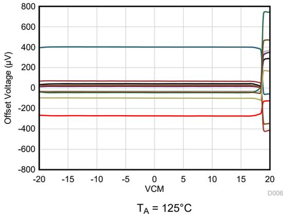
图 4-7. 失调电压与共模电压间的关系
