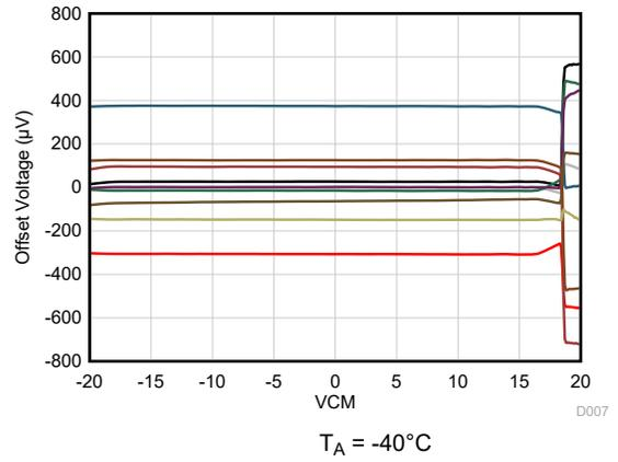
图 4-8. 失调电压与共模电压间的关系
