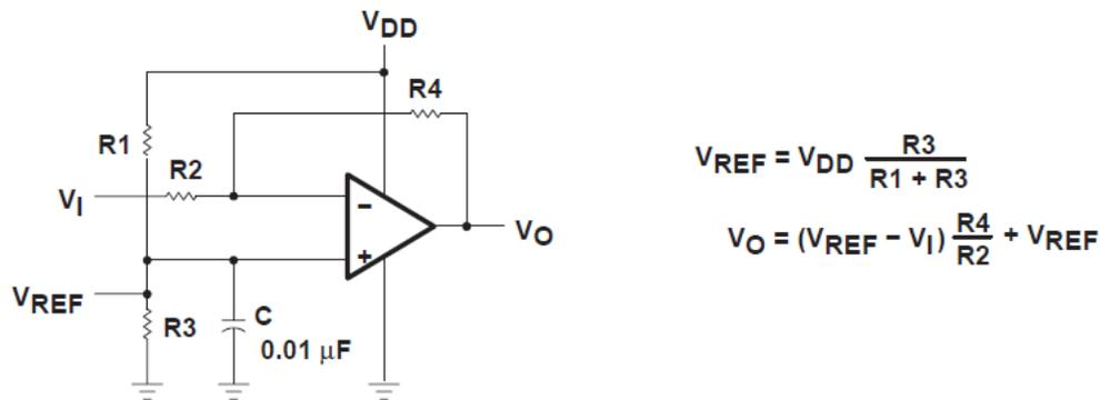
图 6-1. 具有电压基准的反相放大器
