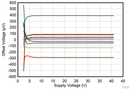
图 4-9. 失调电压与电源间的关系
