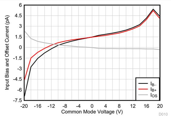
图 4-12. 输入偏置电流与共模电压间的关系
