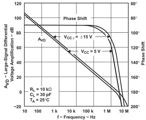
图 6-22. 大信号差分电压放大和相移与频率间的关系
