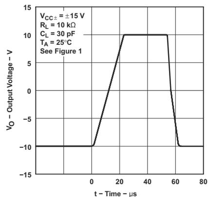
图 6-41. TLE2024 电压输出器大信号脉冲响应
