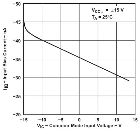
图 6-5. TLE2022 输入偏置电流与共模输入电压间的关系
