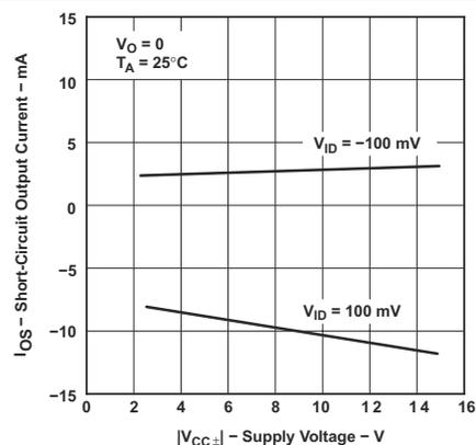
图 6-24. TLE2022 和 TLE2024 短路输出电流与电源电压间的关系
