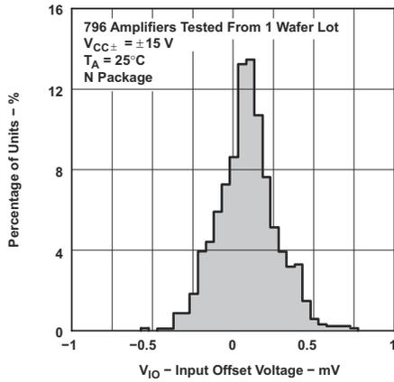
图 6-3. TLE2024 输入偏移电压的分布
