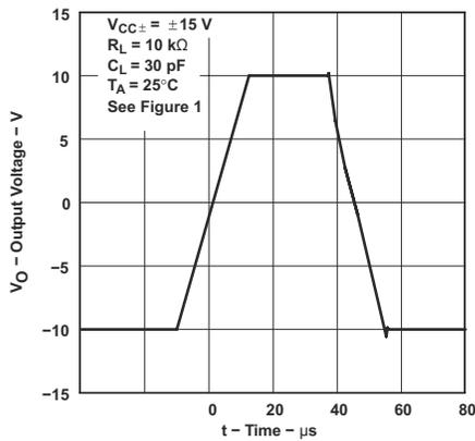
图 6-39. TLE2021 电压输出器大信号脉冲响应
