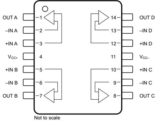
图 5-3. TLE2024 : N 封装 , 14 引脚 PDIP ( 俯视图 )
