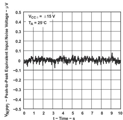
图 6-42. 峰值间等效输入噪声电压, 0.1Hz 至 1Hz
