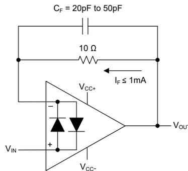
图 7-1. 电压输出器
