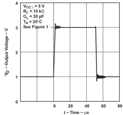
图 6-38. TLE2024 电压输出器大比例脉冲响应
