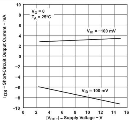
图 6-23. TLE2021 短路输出电流与电源电压间的关系
