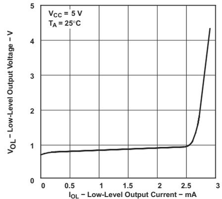
图 6-18. 低电平输出电压与低电平输出电流间的关系
