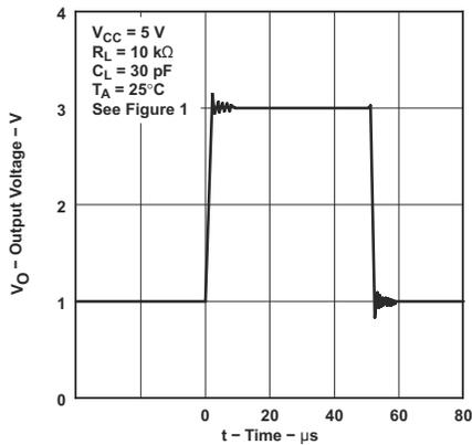
图 6-37. TLE2022 电压输出器大信号脉冲响应
