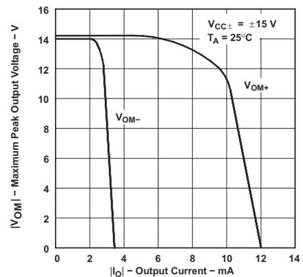
图 6-12. TLE2022 最大峰值输出电压与输出电流间的关系
