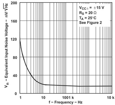
图 6-44. 等效输入噪声电压与频率间的关系
