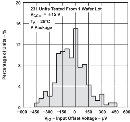
图 6-1. TLE2021 输入偏移电压的分布
