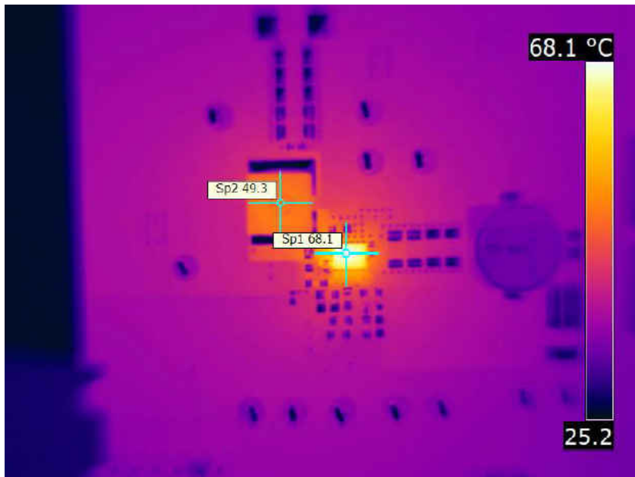
图 10-2. 25°C 环境温度下的热图像
