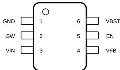
图 5-1. DDC Package 6 Pin (SOT) Top View
