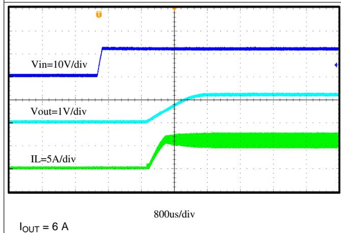
图 27. Start Up Relative to  $V_{IN}$  Rising
