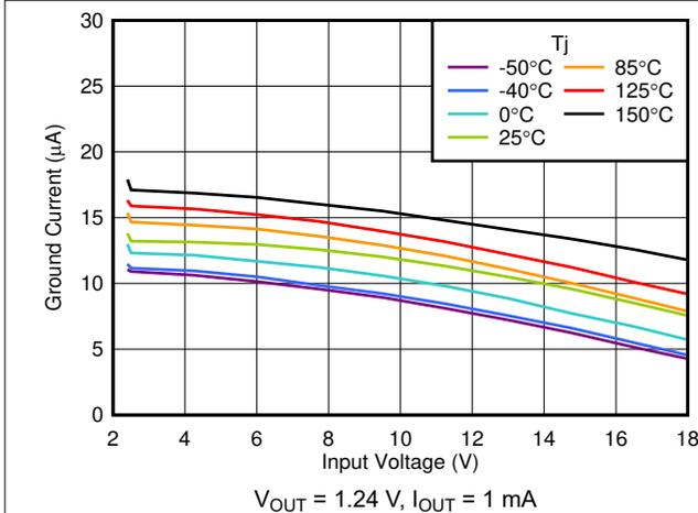
图 6-9.  $I_{GND}$  vs  $V_{IN}$
