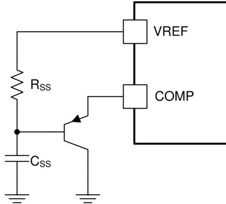
图 7-12. 软启动电路
