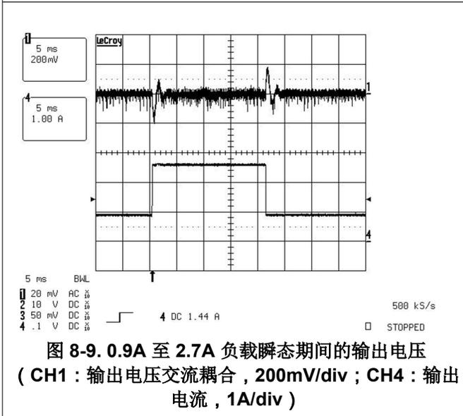
图 8-9. 0.9A 至 2.7A 负载瞬态期间的输出电压 (CH1: 输出电压交流耦合, 200mV/div; CH4: 输出电流, 1A/div)
