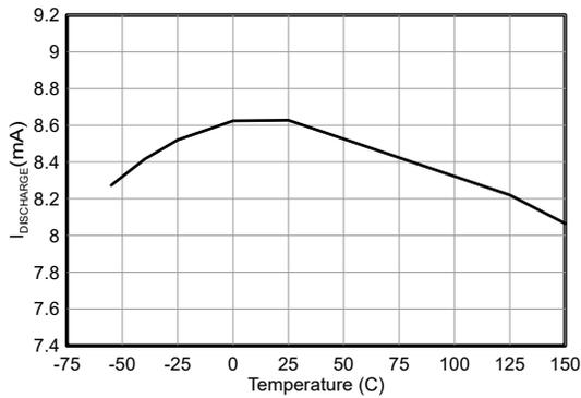
图 6-1. 当  $V_{CC} = 15V$  且  $V_{Osc} = 2V$  时，振荡器放电电流与温度间的关系
