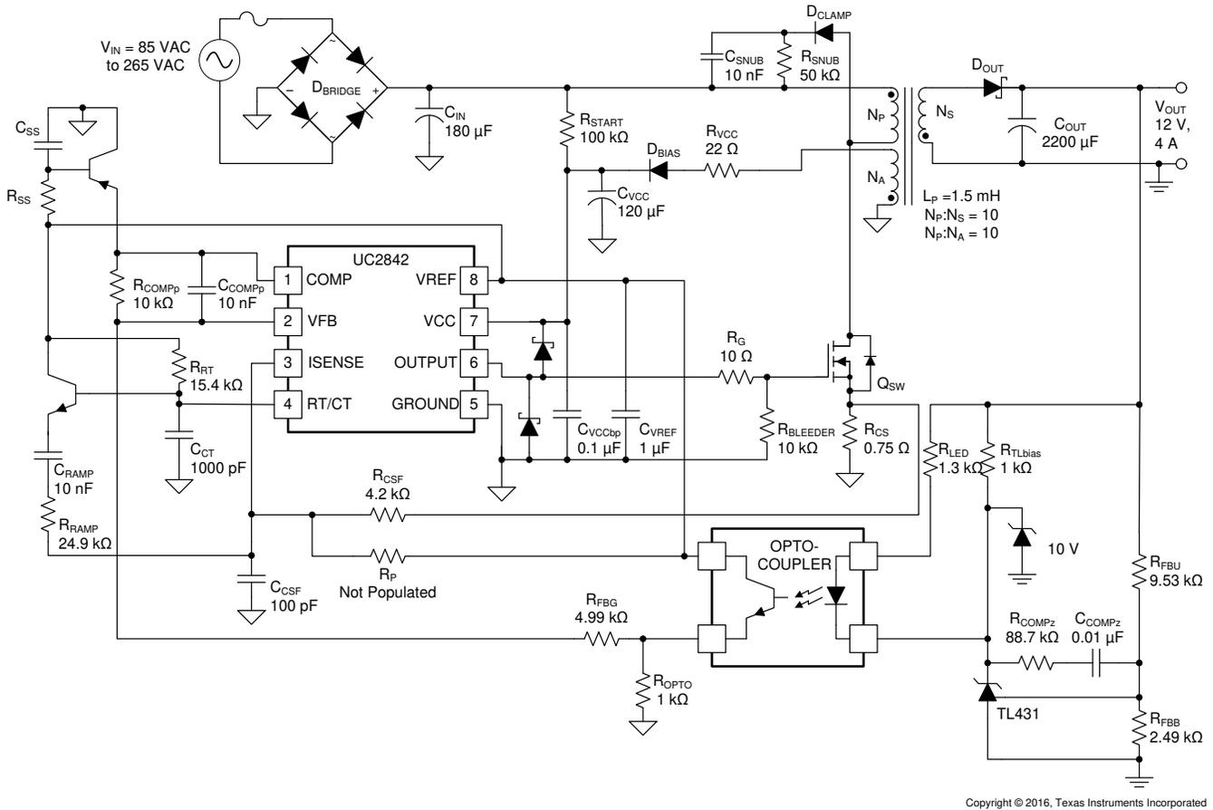
图 8-2. 典型应用设计示例原理图
