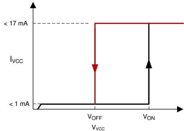
图 7-6. UVLO 导通和关断曲线
