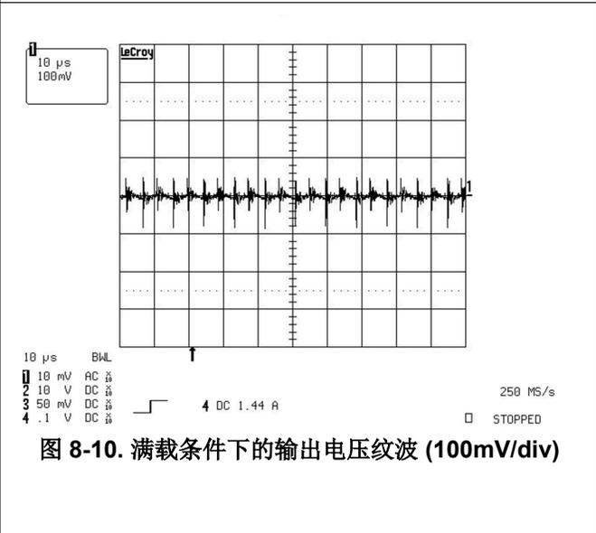
图 8-10. 满载条件下的输出电压纹波 (100mV/div)
