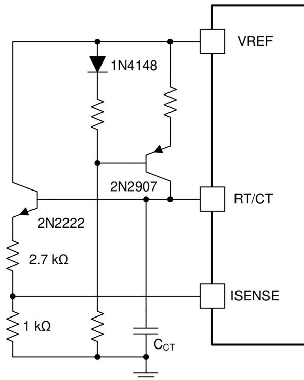
图 7-13. 电流模式 PWM 用作电压模式 PWM
