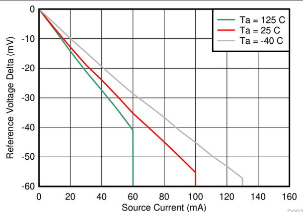
图 6-6.  $V_{REF}$  电压与源电流间的关系
