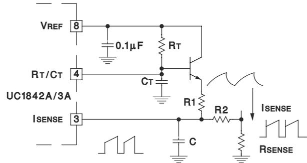
图 7-7. Slope Compensation
