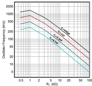
图 6-4. 振荡器频率与时序电阻之间的关系
