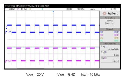
图 9-6. PWM Input and Gate Voltage Waveform
