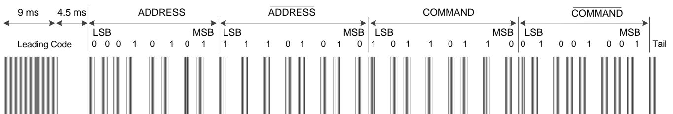
图 13. 脉冲距离协议，数据帧格式
