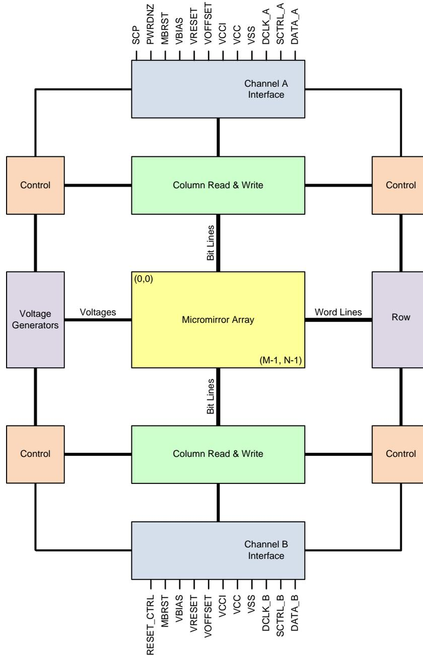
**Figure 2. DLP660TE Block Diagram**
