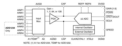
Figure 3. ADS1232/4 Block Diagram
