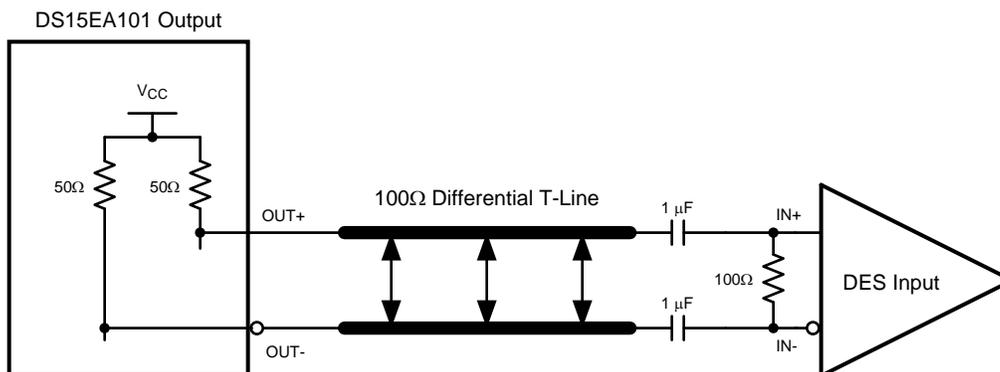
Figure 9. The DS15EA101 Outputs Need to be AC-Coupled to the 24-bit DES Inputs
