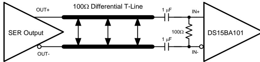
Figure 6. The 24-bit SER Outputs May be AC-coupled to the DS15BA101 Inputs
