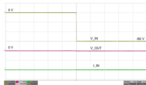
-60V 电源时的反向输入极性保护
