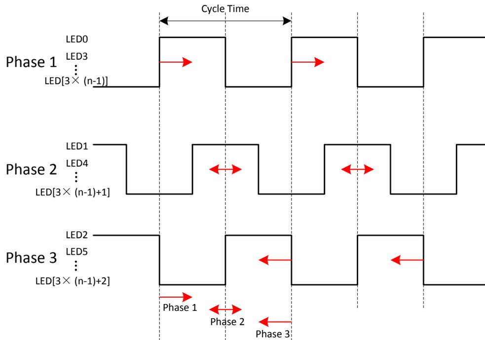
图 12. PWM Phase-Shifting
