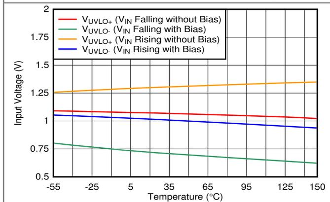
图 33.  $V_{IN}$  UVLO vs Temperature
