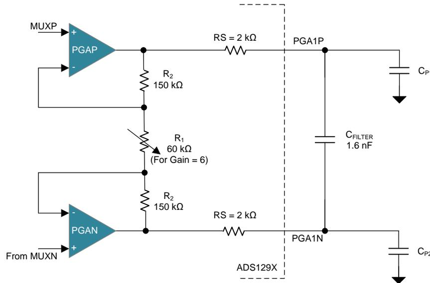
图 10. PGA Implementation in ADS129X Device
