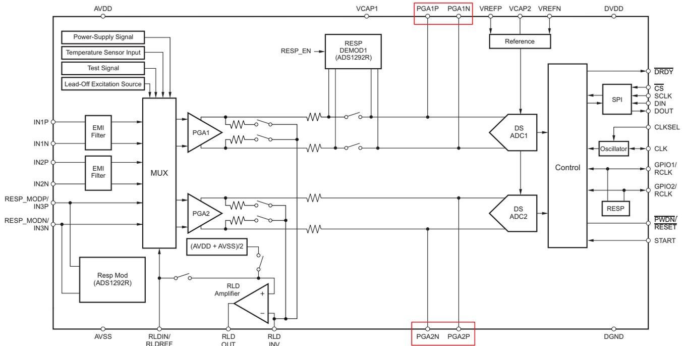
图 9. ADS129X Functional Block Diagram
