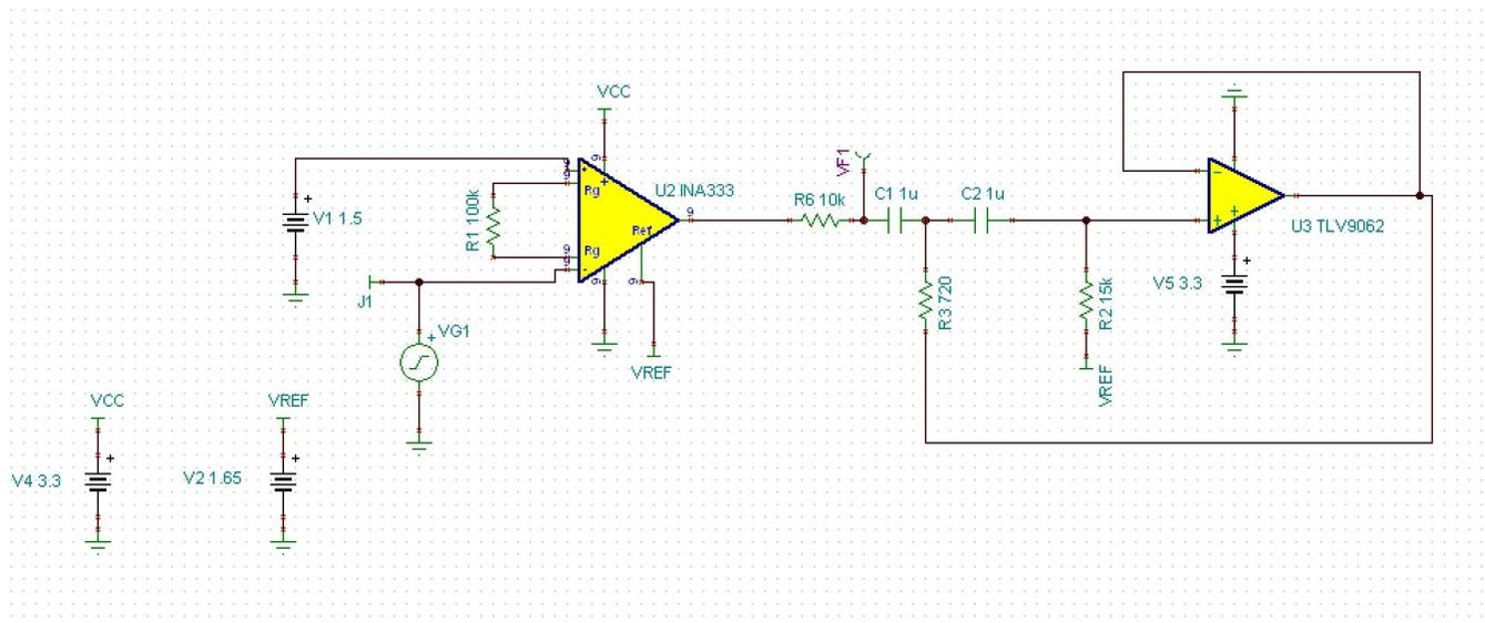
图 18. TINA-TI™ Simulation Circuit of the 50-Hz Notch Filter
