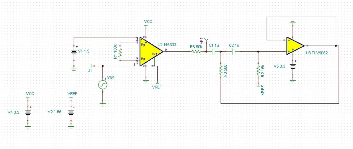
图 16. TINA-TI™ Simulation Circuit of the 60-Hz Notch Filter
