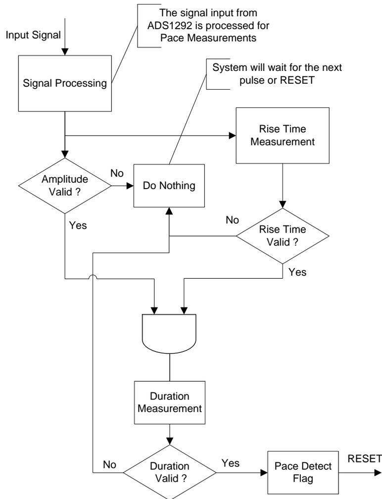
图 7. TIDA-010005 System Flow Diagram
