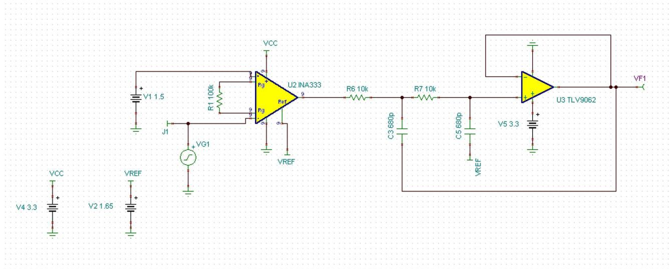
图 13. TINA-TI™ Simulation Circuit of the Low-Pass Filter
