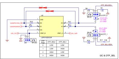
图 4-1. LMK3H0102 和控制引脚
