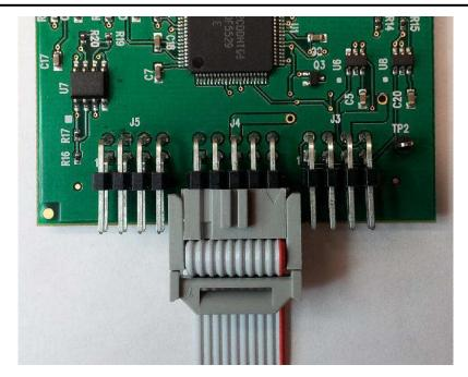
图 3-19. 到 J4 的 10 引脚电缆连接
