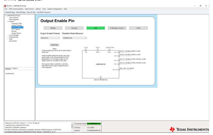
图 3-4. LMK3H0102 向导 "Output Enable Pin" 页面
