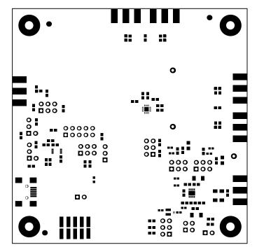
图 4-6. 顶部阻焊层
