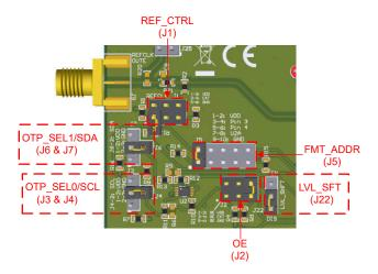
图 2-3. LMK3H0102EVM 控制跳线
