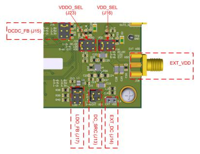
图 2-2. LMK3H0102EVM 电源跳线
