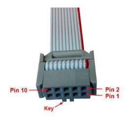
图 3-20. 10 引脚电缆引脚排列
