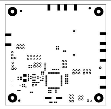
图 4-11. 底部阻焊层
