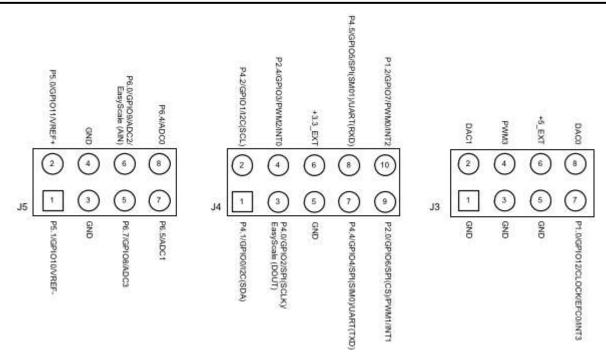
图 3-21. USB2ANY 板连接器引脚排列图
