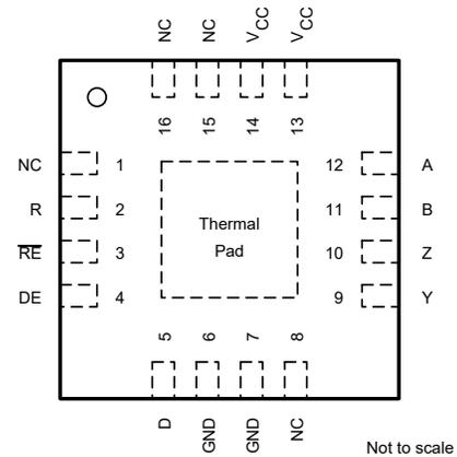
**Figure 5-2. RSA Package (QFN)
