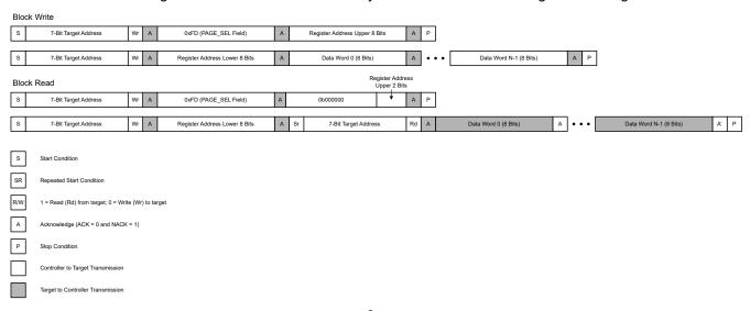
Figure 7-11. I<sup>2</sup>C 1-Byte Mode
