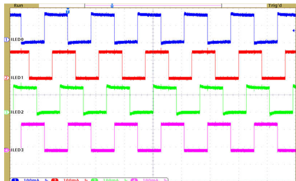
図 8-3. 位相シフト PWM 動作を示す LED ストリング電流
