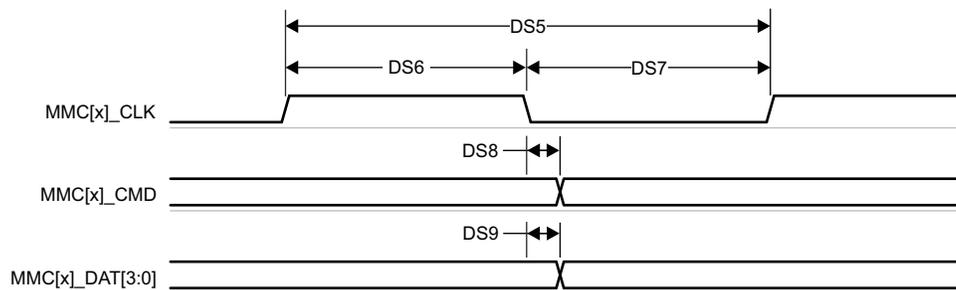
**図 6-67. MMC1 – デフォルト速度 – 送信モード**
