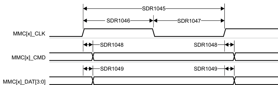
図 6-99. MMC1 – UHS-I SDR104 – 送信モード
