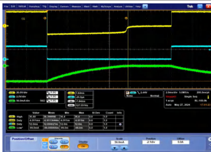
図 9-5. CQ 電源オン遅延、 t_{(UVLO)} (ピン モードまたは SPI モードでのデフォルトの 00b 設定)
