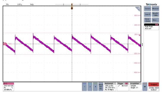
Figure 3-8. VISO AC Ripple: Vpkpk =56 mV, VINP=5 V, VISO=5 V, ILOAD=0 mA
