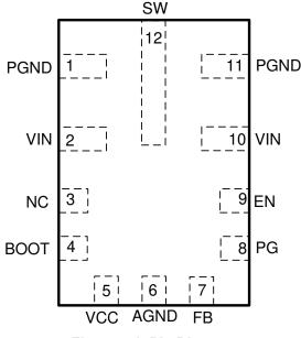
Figure 4-1. Pin Diagram
