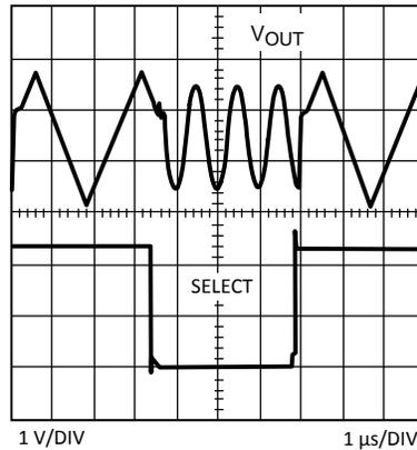
**Figure 47. 2:1 MUX Output**
