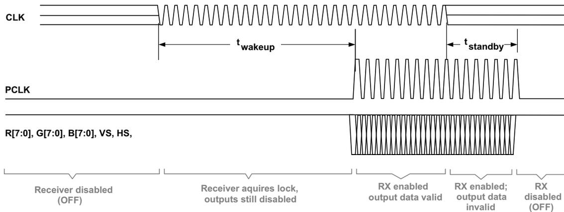
**Figure 17. Standby Detection**
